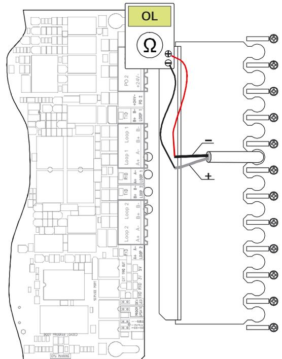
3. На время измерения замкните провода линии устройств сигнализации в пожарной панели.
