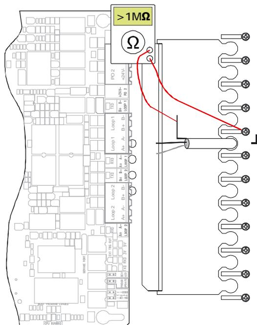
5. Если используются неэкранированные кабели, то измерьте сопротивление между проводниками и корпусом пожарной панели. Оно также должно превышать 1 Мом.
