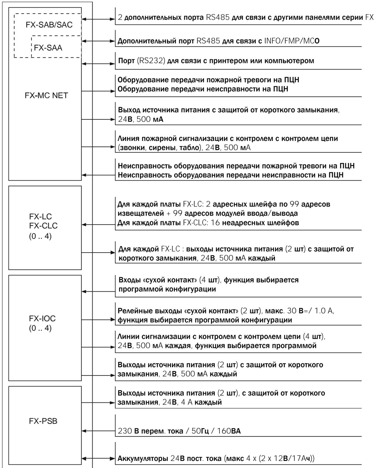
19.2 Внешние подключения панели FXM/RU
