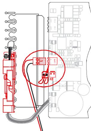
2. Проверьте полярность аккумуляторов по маркировке.
