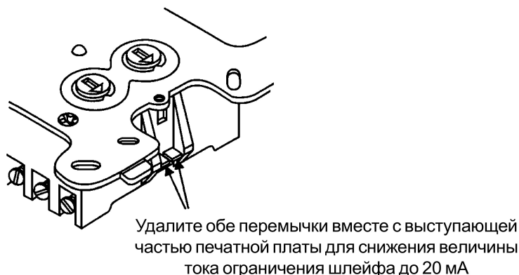
Рис. 3. Удаление перемычек для снижения величины тока ограничения шлейфа
