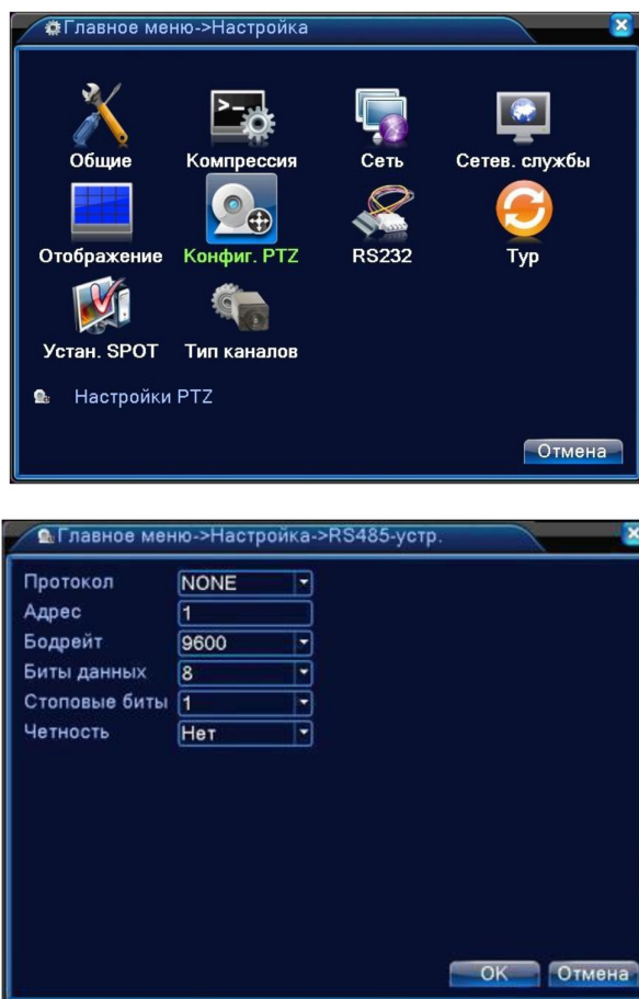
Рисунок 4.33 Конфигурация RS485 устройств в цифровом режиме.
