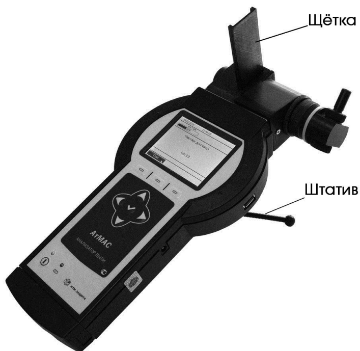
Рисунок 7. Очистка датчика от пыли.
