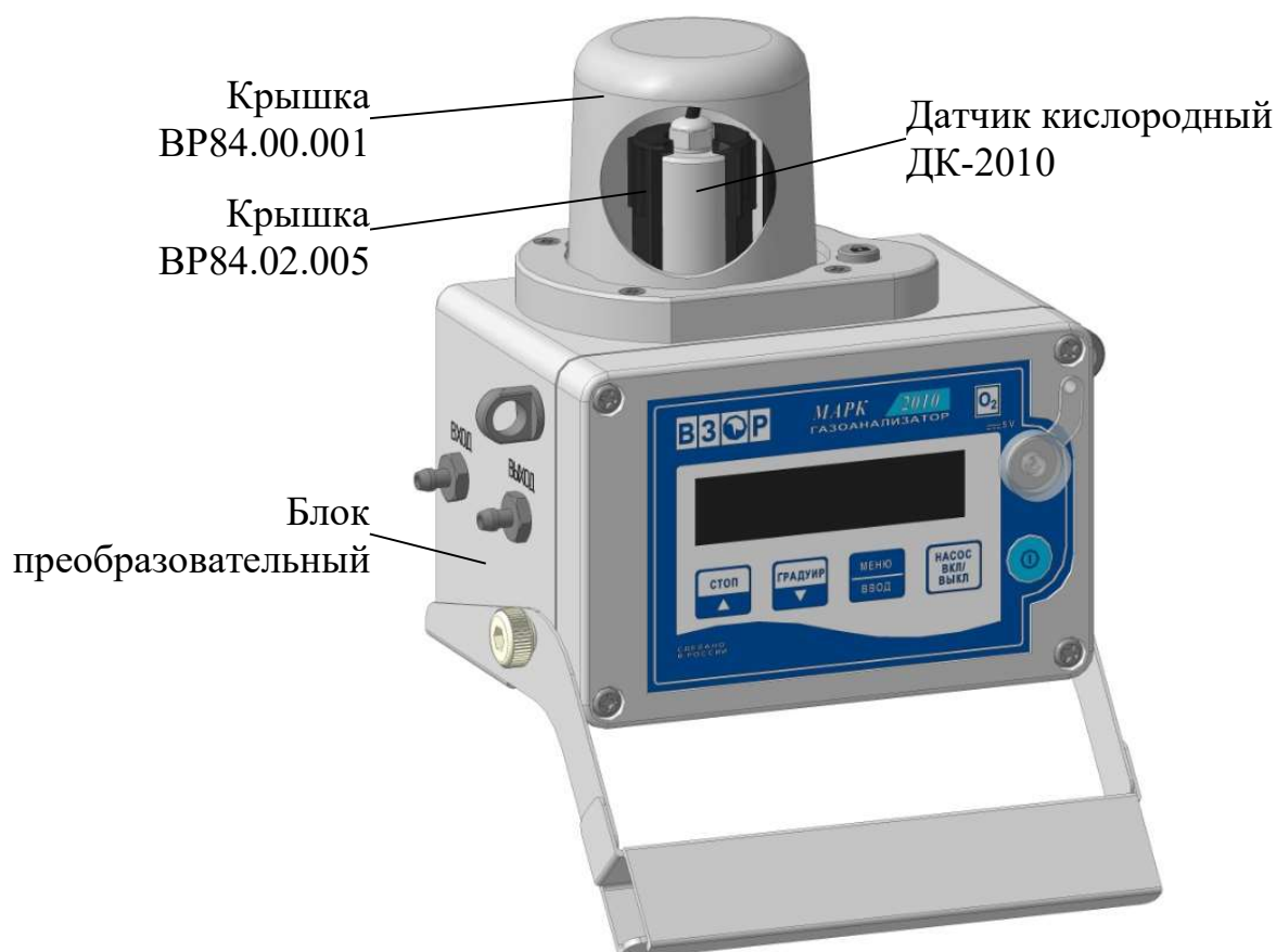
Рисунок 1.1 – Газоанализатор МАРК-2010 (вид с местным разрезом)
