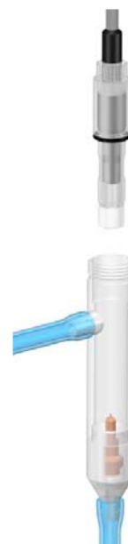
Рис. 3.9. Установка АСрН 2 в измерительную камеру.
