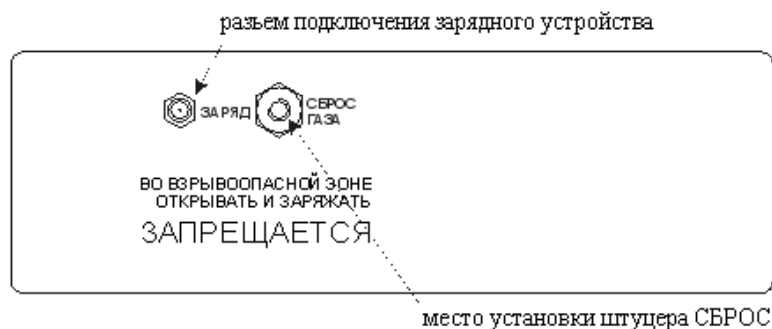
Рис. 2. Передняя (а) и задняя (б) панель газоанализатора
