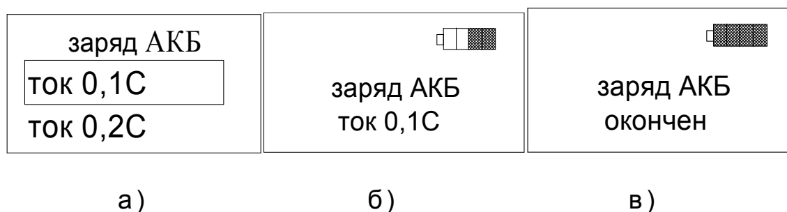
Рисунок 3.1 – Сообщения на табло при заряде АБ
