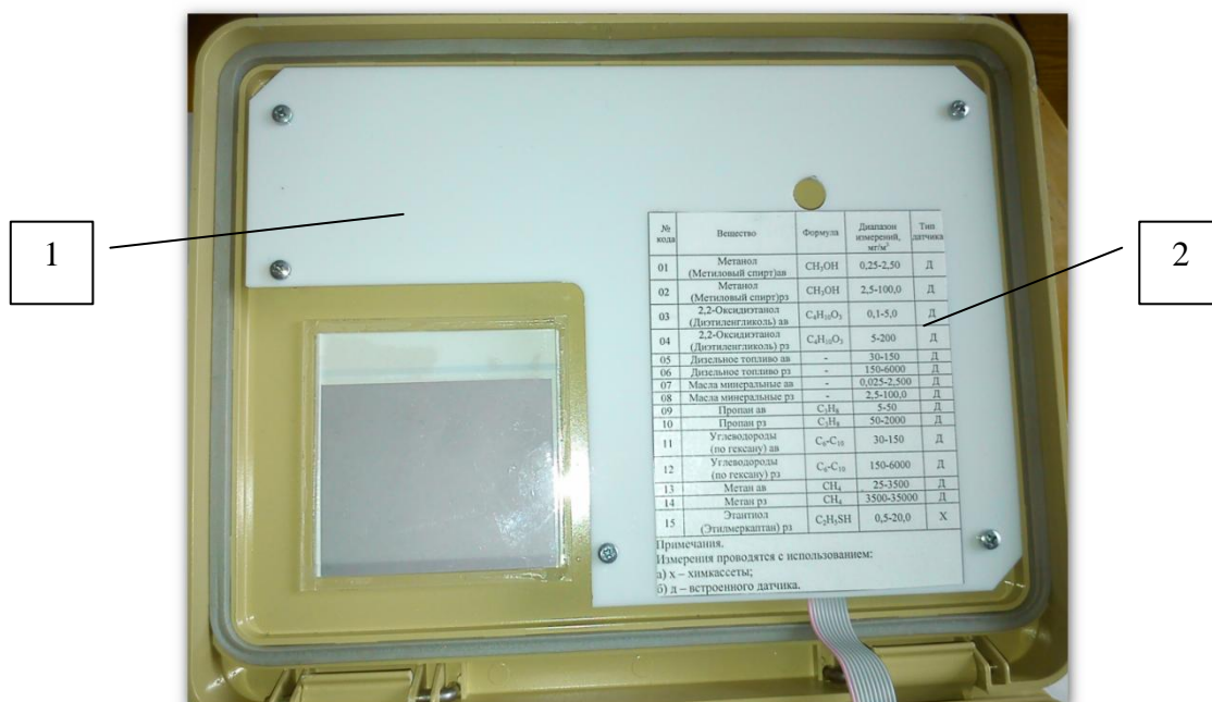
Рисунок 4 – Внутренняя сторона крышки. 1 – Защитный экран; 2 – Табличка с названиями измеряемых веществ и их диапазоны измерения (этикетка).
