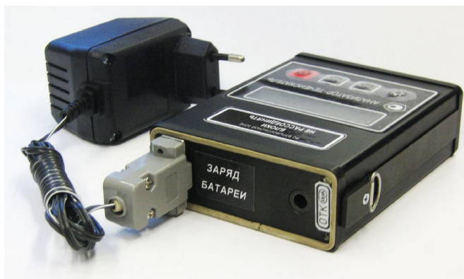
Рисунок 7.1. Подключение зарядного устройства к блоку ОИ.
