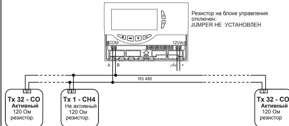
Fig. 7: Пример соединения : Сенсор-Сенсор.
