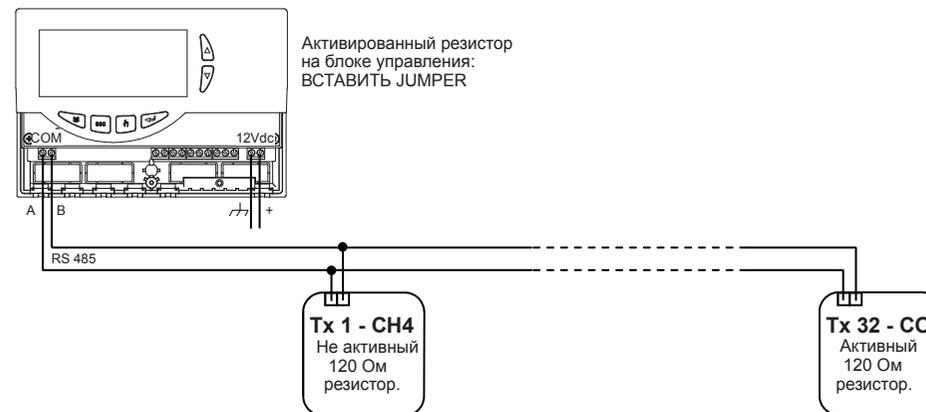
Рис. 6: Пример соединения : Блок контроля - сенсор
