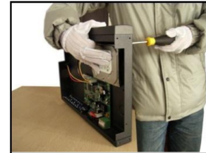
3.закрутите винты жесткого
