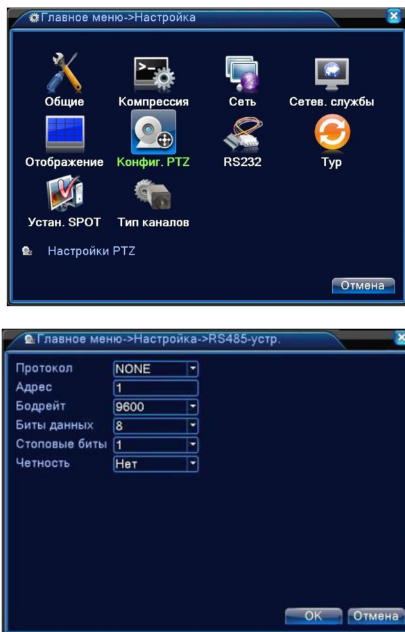
Рисунок 4.33 Конфигурация RS485 устройств в цифровом режиме.
