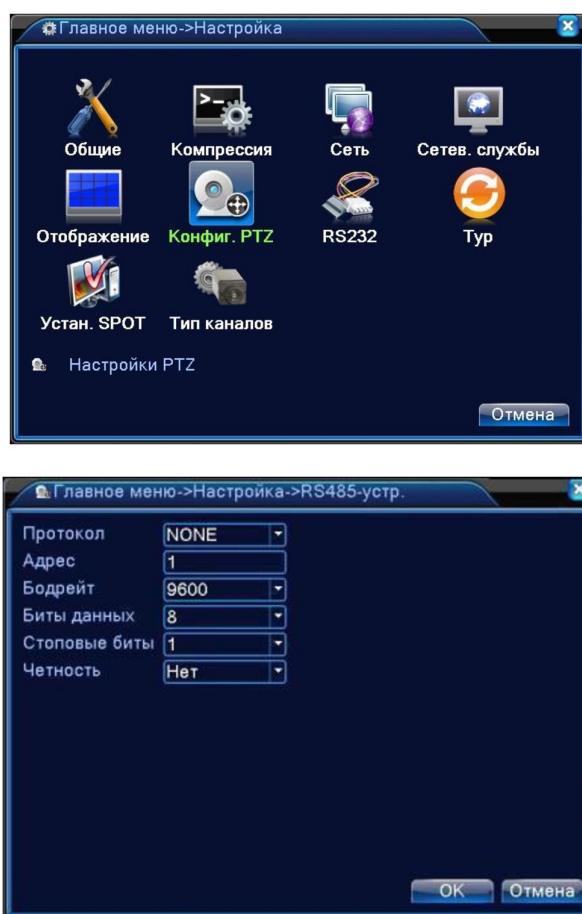
Рисунок 4.33 Конфигурация RS485 устройств в цифровом режиме.
