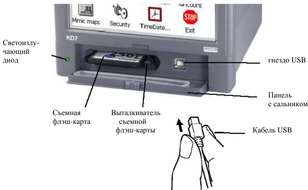
Рис. Вид самописца спереди после открытия панели
